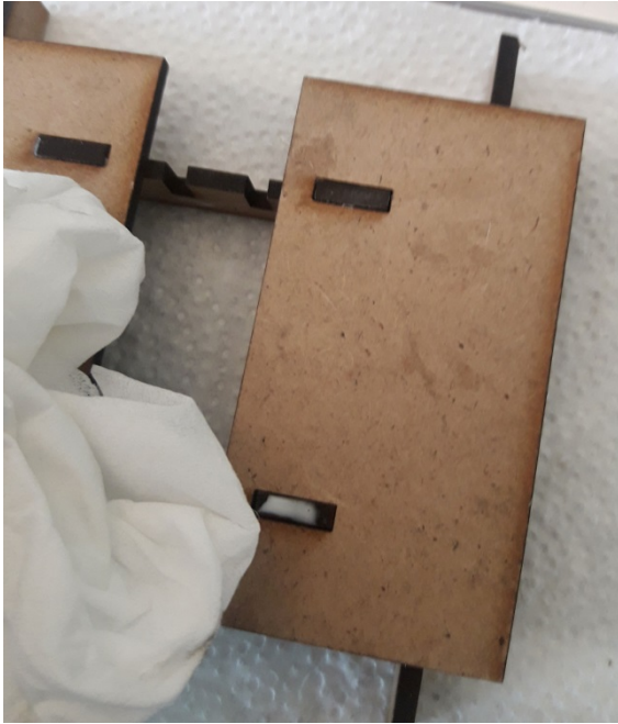
Abbildung 21 - Andrücken der Platte und entfernen von überschüssigem Leim
