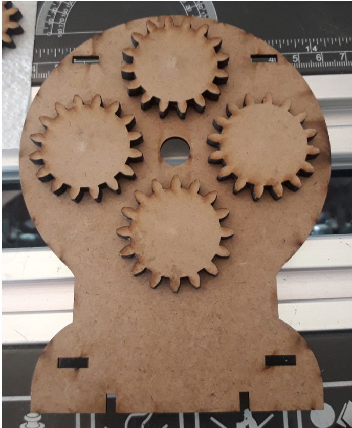
Abbildung 4 - Haken inkl. Zahnräder sind befestigt - Rückseite
