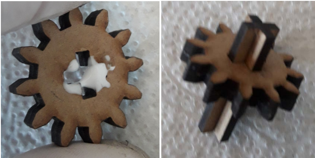
Abbildung 8 - Welle in mittleres Zahnrad einkleben
