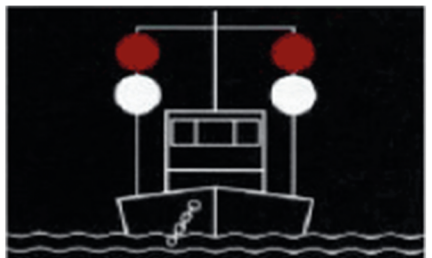
Schwimmendes Gerät bei der Arbeit sowie festgefahrenes oder gesunken- nes Fahrzeug
