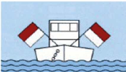
Schwimmendes Gerät bei der Arbeit sowie festgefahrenes oder gesunken- nes Fahrzeug
